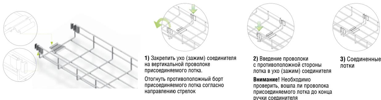
Рис. 2. Проволочные лотки ВАКС KDSZ с приваренными соединителями
