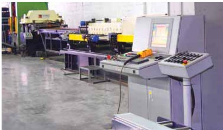
Рис. 5. Линия по производству металлических лотков на заводе «ДКС Украины» (с. Иванков)
